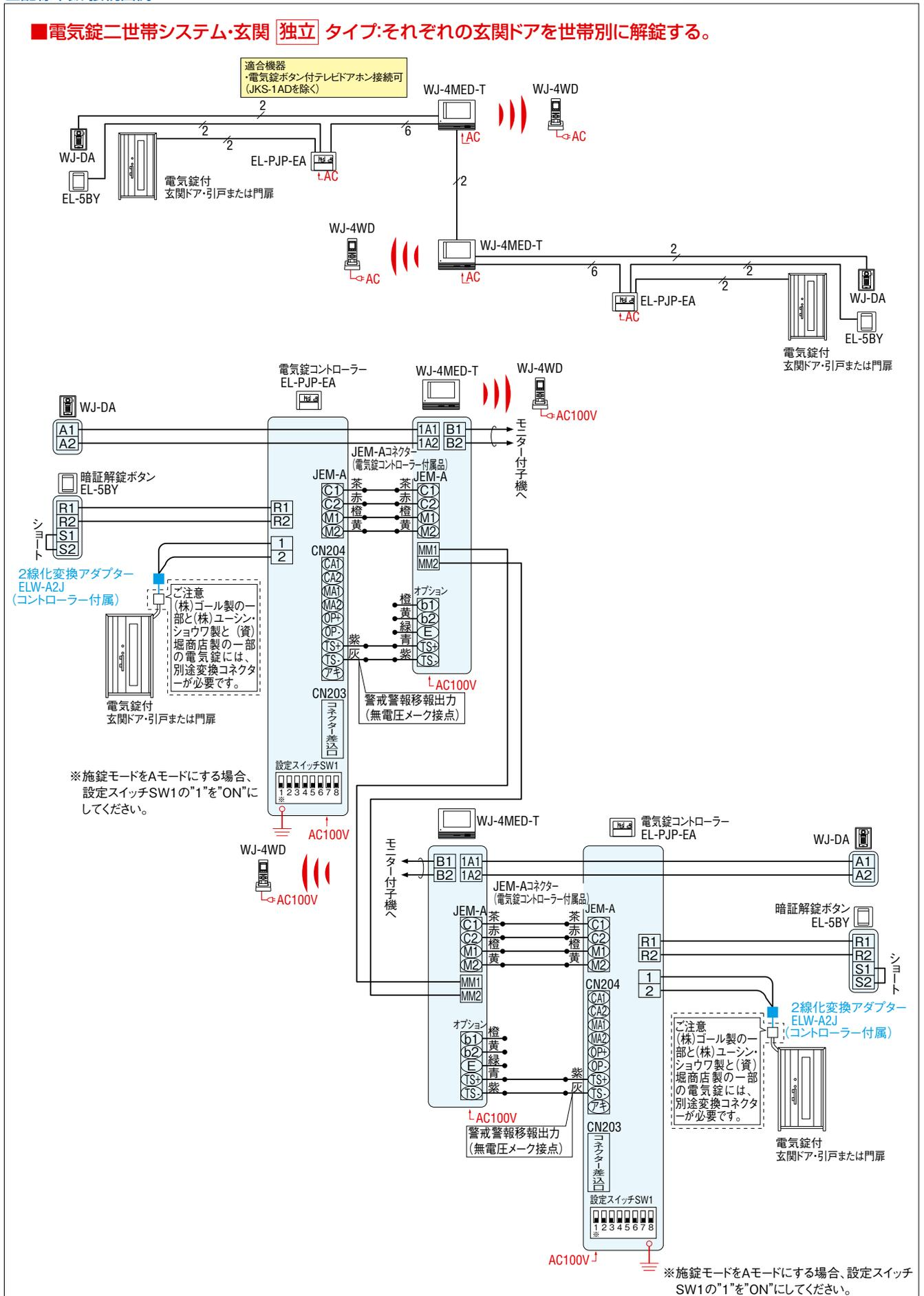
テレビドアホン配線上的ご注意:インターホン系のケーブルと電気錠系のケーブルは別ケーブルとし、それぞれ10cm以上離して配線してください。
